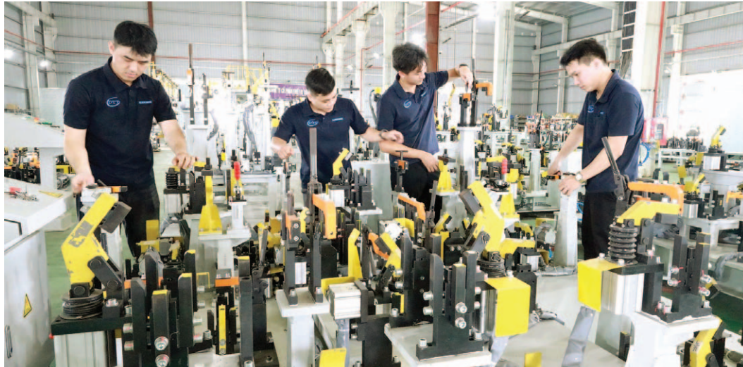
Viện Nghiên cứu Cơ khí thiết kế, chế tạo dây chuyền thiết bị, đồ gá hàn xe ô tô
