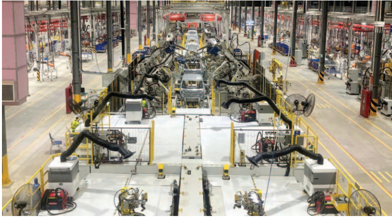
Viện Nghiên cứu Cơ khí cung cấp dây chuyền thiết bị, đóng gá hàn cho nhiều dòng xe điện
