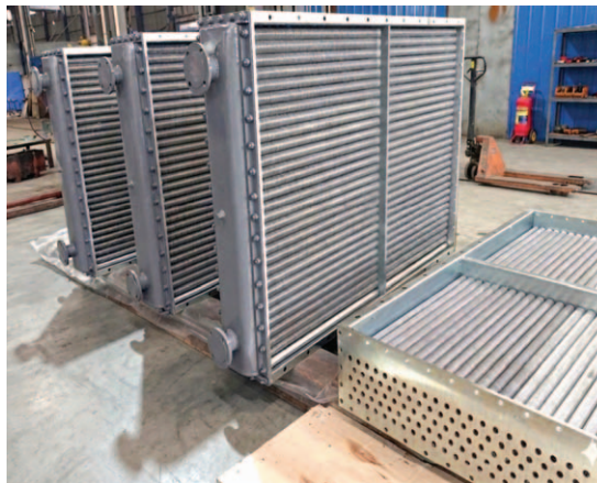
Bộ làm mát không khí máy phát kiểu cánh tản nhiệt dạng cánh xoắn do Narime chế tạo Ảnh: Q.N
