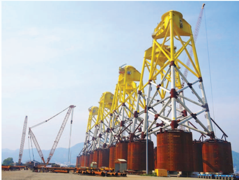
Hệ thống chân đế điện gió ngoài khơi do Tổng công ty Cổ phần Dịch vụ kỹ thuật Dầu khí Việt Nam (PTSC) chế tạo cho đối tác nước ngoài. Ảnh: Thuà Ngọc
