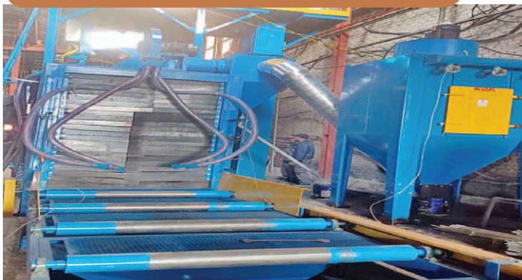
Máy bắn bi bằng tải con lăn tại Công ty TNHH Cơ khí Xây dựng và Thương mại Dũng Thanh. Ảnh: Trung tâm TV&HTPT Công Thương Nghệ An
