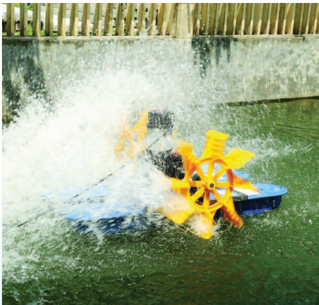
Máy guồng nước tạo oxy cho tôm cá - sản phẩm CNNT đồng hành cùng ngành thủy sản. Nguồn: Bảo Thoa
