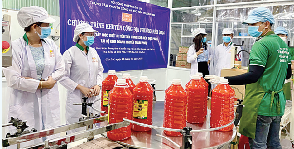
Hệ thống chiết rót, cấp siết nắp và dán nhãn tự động được hỗ trợ từ nguồn kinh phí khuyến công của Gia Lai năm 2024 tại hộ kinh doanh Nguyễn Thành Phúc
