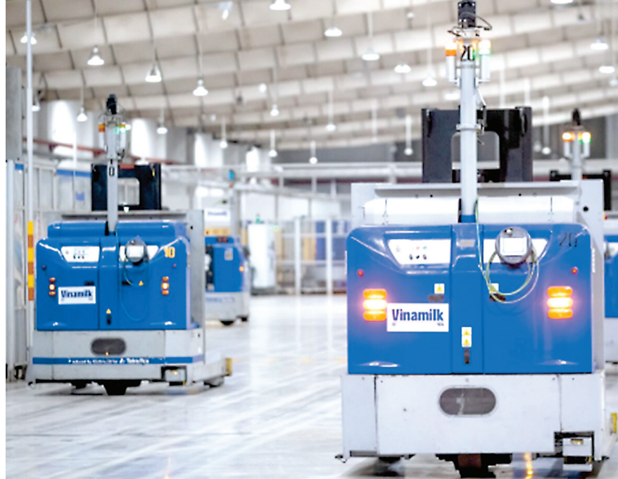
Các robot LGV giúp giảm 62% lượng khí thải CO 2 so với xe nâng chạy nhiên liệu hóa thạch - Ảnh: Nam Anh
