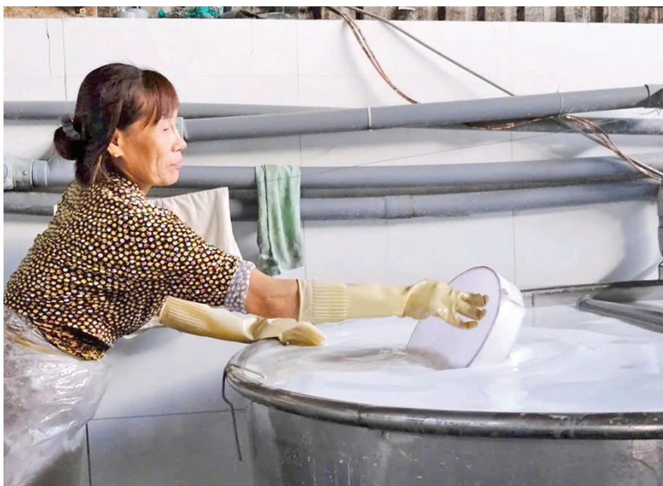
Công đoạn lọc nước bột trong quy trình sản xuất bột gạo tại cơ sở truyền thống ở Sa Đéc
